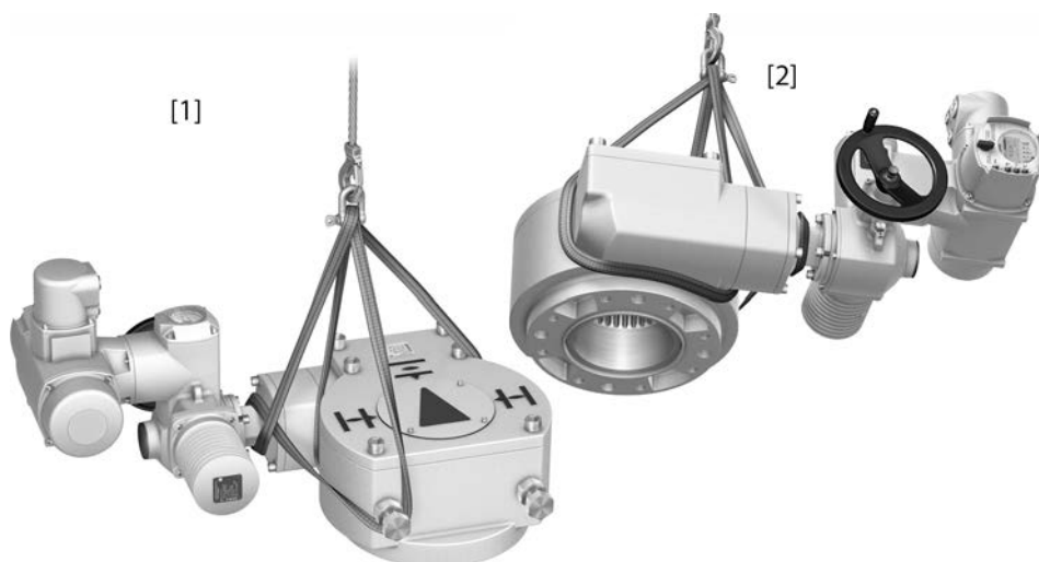
図 9: GQB 200.1とSA.2とAC.2の例、水平吊り上げ
