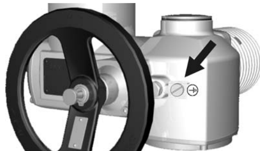
図 20: アース接続部
