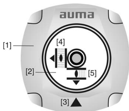
図 27: 機械式開度表示器
