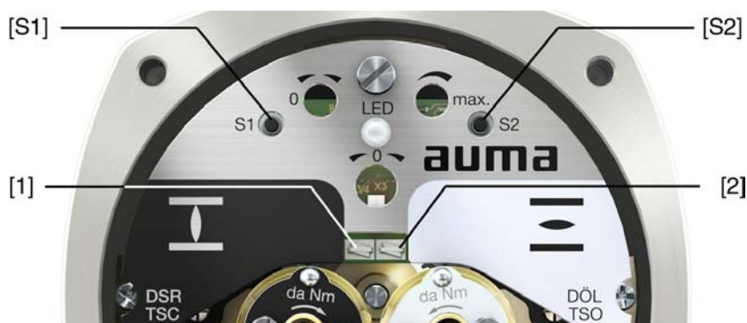
図 33: スイッチ収納部が開いた状態でのコントロールユニットのイメージ
