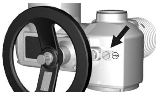
図 24: アース接続部
