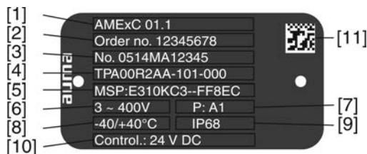
図 3: アクチュエータ制御装置銘版
