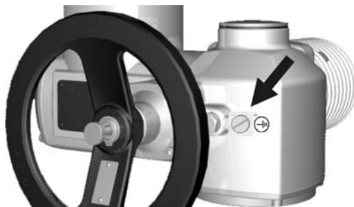
図 20: アース接続部
