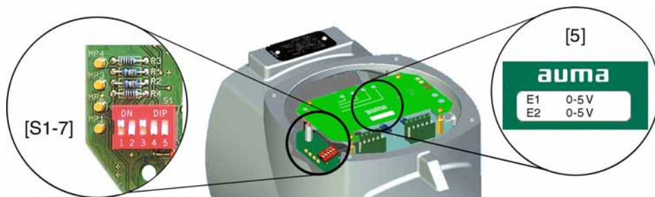
図 50: ポジショナーのボード上に追加スイッチのあるタイプ
