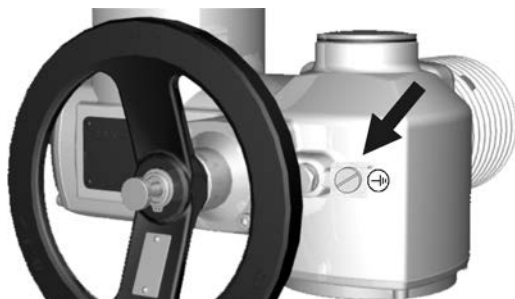
図 23: アース接続部
