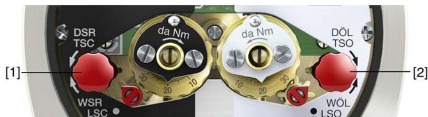
1. テストボタン [1] を矢印方向 DSR に回します: トルクスイッチ「閉」が作動します。
