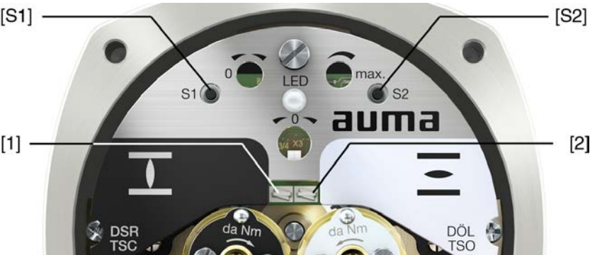
図 40: スイッチ収納部が開いた状態でのコントロールユニットのイメージ
