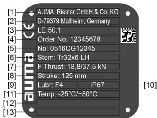
図 2: リニアスラストユニット銘板（例）
