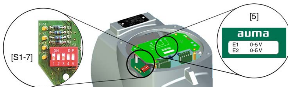
図 60: ポジショナーのボード上に追加スイッチのあるタイプ
