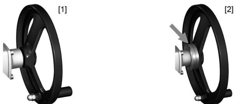
図 32: 過負荷保護装置無し/有り手動ハンドル
