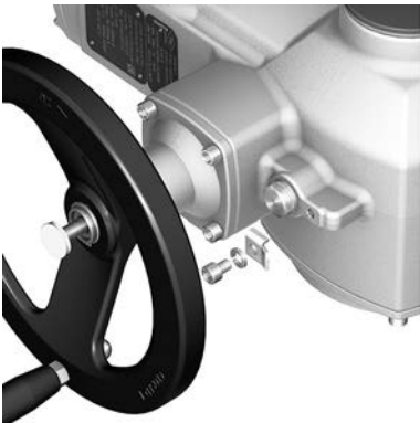
図 30: マルチターン型アクチュエータアース接続部
