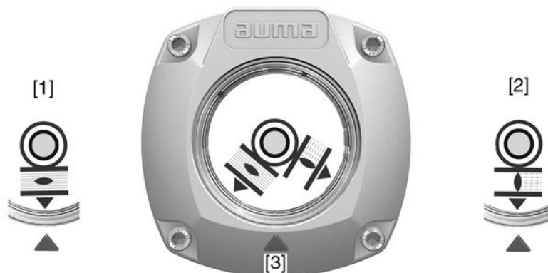
図 67: 機械式開度表示器
