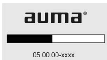
図 44: ファームウェアのバージョンを表すスタートメニュー: 05.00.00-xxxx
