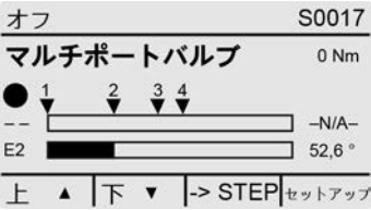
図 48: マルチポートバルブの状態表示(セクタスイッチの位置OFF)
