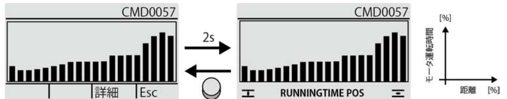
図 60: ヒストグラム「モータ運転時間-位置」の例
