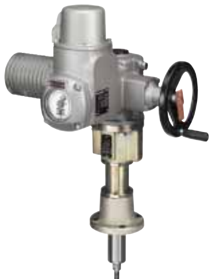
リニアスラストユニットLE付き マルチターンアクチュエータSA/SAR スラスト 4kN~217kN ストローク 最大500mm スラスト速度 20~360mm/min
