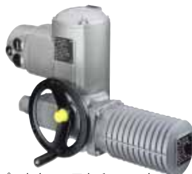
パートターンアクチュエータ SG 05.1 – SG 12.1 トルク 100~1 200Nm 作動時間: 4~180秒/90°
