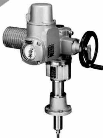
リニアスラストユニット LE 付き マルチターンアクチュエータ SA スラスト: 4 – 217kN ストローク: 最大 500mm スラスト速度: 20 – 360mm/分
