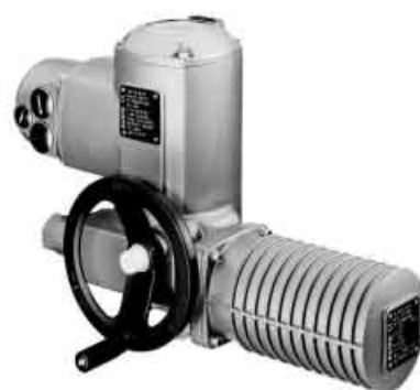
パートターンアクチュエータ SG 05.1 – SG 12.1 トルク: 90 – 1200Nm 作動時間: 4 – 180 秒/90°
