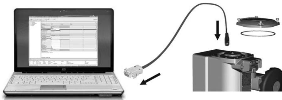
コンピュータとアクチュエータ内蔵制御装置間の接続確立のためにサービスケーブル (AUMA 品番: Z100.999) が必要です。
