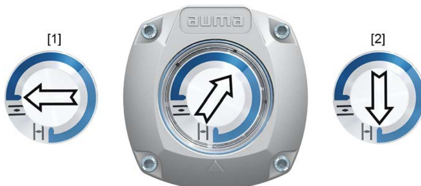
図 62: 機械式開度表示器
