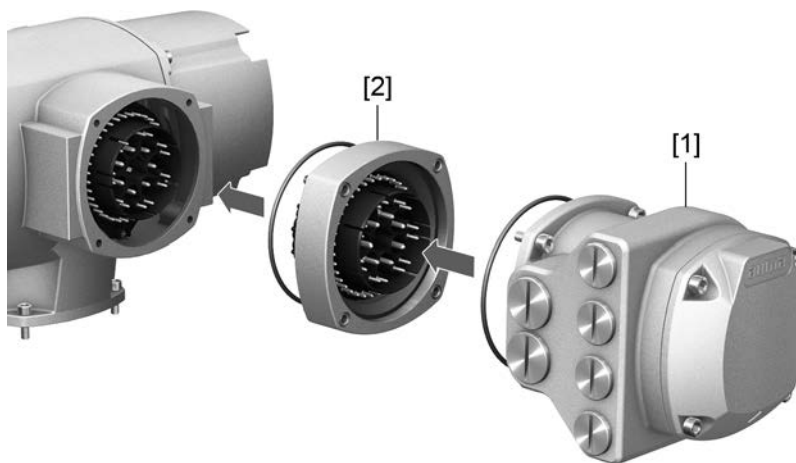
図 29: 中間フレーム DS との電気接続部
