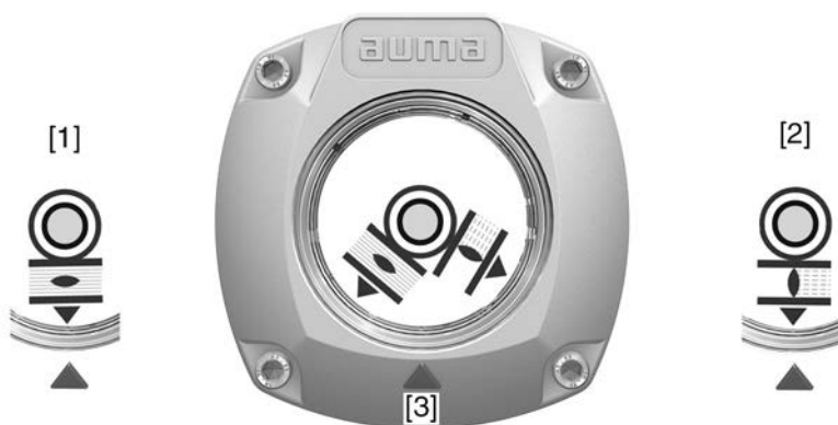
図 63: 機械式開度表示器
