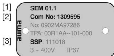
図 4: 現場操作機銘板
