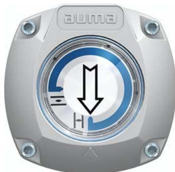
自己調整型機械式開度表示器はバルブ設定を矢印⇓により示します。正しい設定では矢印は終端位置で記号☐ (開) または⊥ (閉) を示します。
