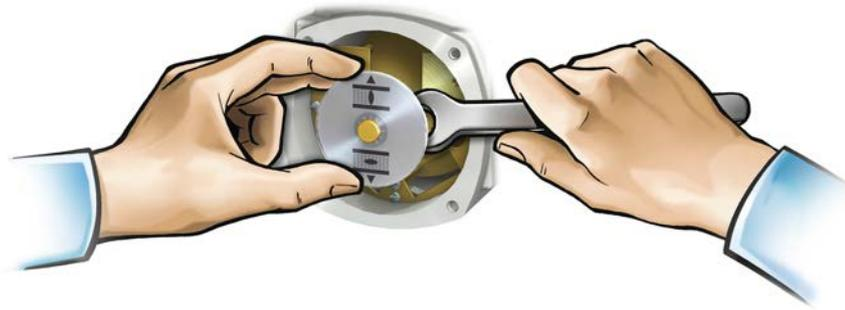
2. アクチュエータの回転/ストロークが減速ギアの設定 (1 - 9段階) と一致しているか表に従い点検します。
